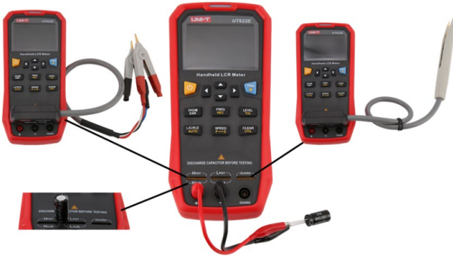
Рисунок 3-1. Тестирование электронных компонентов
